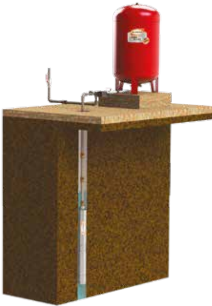
DIAGRAMA DE INSTALACIÓN PARA HIDRONEUMÁTICO
