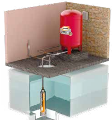
DIAGRAMA DE INSTALACIÓN PARA HIDRONEUMÁTICO
