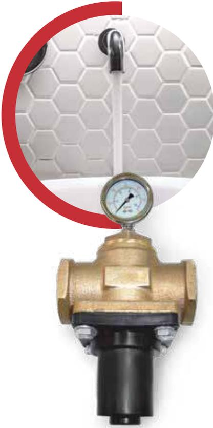
Las válvulas reductoras de presión roscada se utilizan en aplicaciones donde los requerimientos de presión varían de unos servicios a otros. Generalmente, los sistemas de bombeo y de presión deben ser calculados en base a la aplicación que requiera la mayor presión (por ejemplo: el piso más alto de una torre), aun así deben considerar otras aplicaciones donde necesiten menor presión (por ejemplo: el piso mas bajo de una torre).
