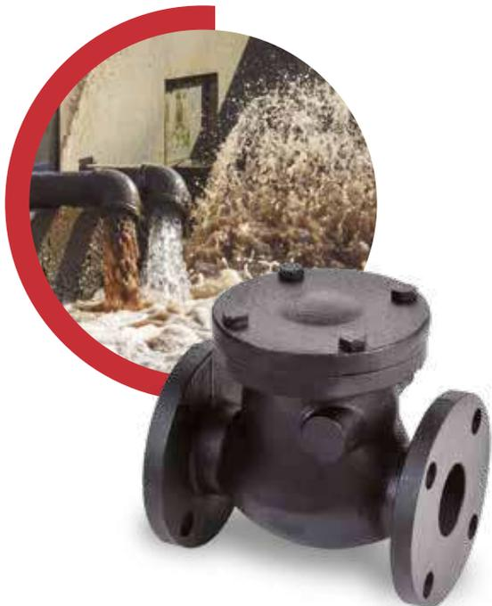
Esta válvula check permite que el fluido pase y evita regresión del mismo. Tiene un disco pasador de alta resistencia, que está suspendido dentro del cuerpo de la válvula, abre y cierra automáticamente mediante la presión del fluido, cuando la presión empieza a descender este disco se cierra disminuyendo considerablemente el golpe de ariete y así puede proteger su tubería y bomba.
